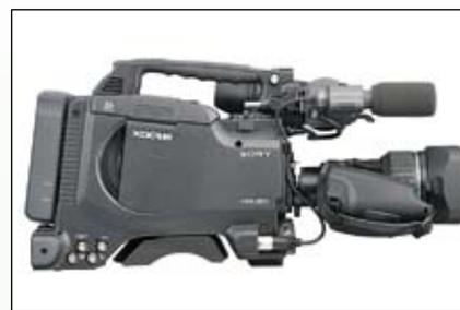
матами MPEG HD и DVCAM, для высококачественного мониторинга или записи имеется выход HD-SDI. Помимо объективов 1/2 дюйма, с помощью дополнительного адаптера можно установить объектив 2/3 дюйма.
